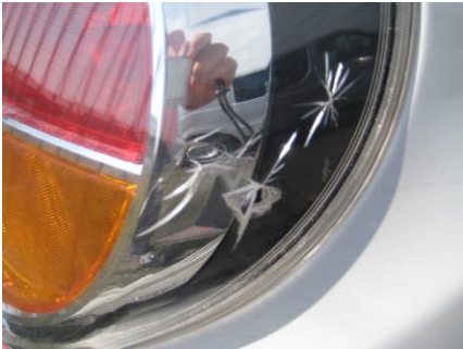
Beschadigingen licht units
